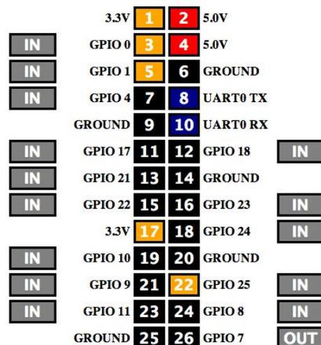
Avec cet écran par défaut, vous pouvez modifier les fonctions du GPIO d'entrée à sortie, et changer l'état des broches. Il suffit de cliquer sur les boutons IN/OUT, et sur chaque broche pour changer son état
