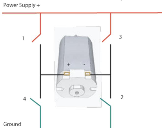
l'alimentation à la borne + du moteur et la masse à la borne - et le moteur se met à tourner. Sinon, fermer les commutateurs 3 et 4 connecte la masse à la borne + et le positif à la borne - et le moteur tourne à l'envers.
