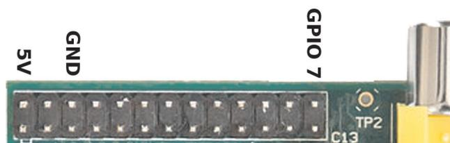
Trois fils seulement sont nécessaires pour le GPIO : +5V, GND et GPIO 7 (CE1) pour la broche que j'utilise pour contrôler l'émetteur.
